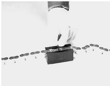
Trennen der Poly-Stahl-Kette
