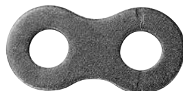
Beispiel eines Risses
