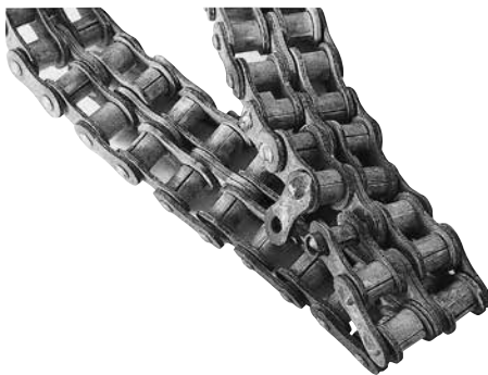
Korrosion einer Rollenkette aus Edelstahl
