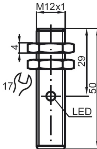
Der Schaltweg des Schaltringes aktiviert bei Überlast den Initiator. Dieser muss unter Einhaltung der herstellereigenen Abstandsmaße zu dem Schaltring auf einer festen Halterung montiert sein.
